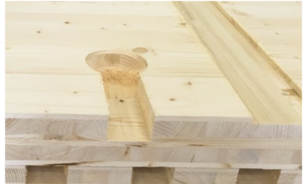
2. Fraise – fraisage des rainures avant le collage des panneaux.
