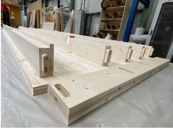
Exemple d'usinage personnalisé NOVATOP OPEN – Tenon.
