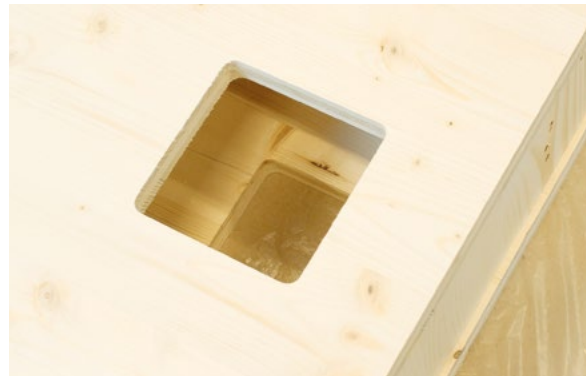
Fraisage d'ouvertures carrées avec rayon.
