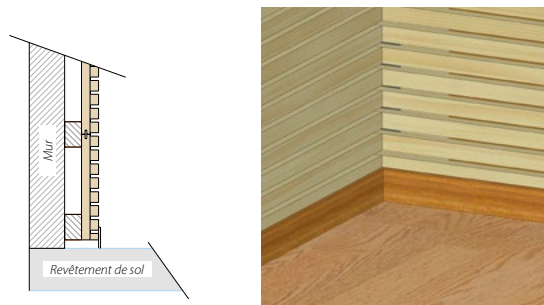
Détail de la finition par un tasseau
