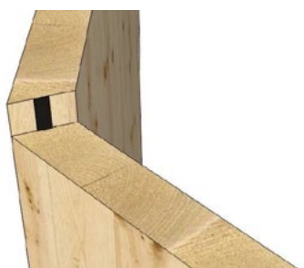
DÉTAIL D'ANGLE (ENV. À 135° ET PLUS), MI 124, 84, 62 / Particolare del giunto nell'angolo (cca. 135° e di più) PI 124, 84, 62
