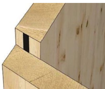
DÉTAIL D'ANGLE (ENV. À 135° ET PLUS), MI 124, 84, 62 / Particolare del giunto nell'angolo (cca. 135° e di più) PI 124, 84, 62
